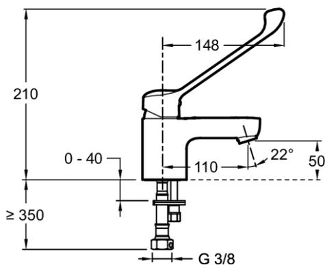
Descripción: Monomando de lavabo - maneta "Easy". E16024-4ND. Colección: JULY. PESO: 1,2 kg. MATERIAL: Metal. TIPO DE INSTALACIÓN: 1 orificio. TIPO: Monomando. CAUDAL: 13 l/min. ALTURA TOTAL DE LA GRIFERÍA: 210. SALIDA DE CAÑO: 110. RACORES: Con flexibles de alimentación. DESAGÜE: Con. GARANTÍA DEL MECANISMO: 5 años. Larga palanca de 150 mm. Cartucho secuencial.
