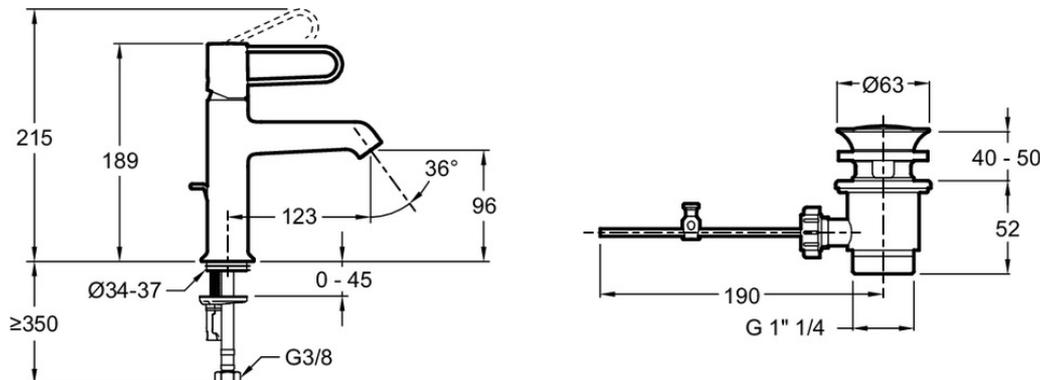
Descripción: Monomando de lavabo con desagüe. E21028-BL. Colección: ODÉON RIVE GAUCHE. DIMENSIÓN: 18,90 x 4,50 cm. PESO: 1,3 kg. MATERIAL: N/A. TIPO DE INSTALACIÓN: 1 orificio. TIPO: Monomando. CAUDAL: 5 l/mn. ALTURA TOTAL DE LA GRIFERÍA: 189. SALIDA DE CAÑO: 123. RACORES: Con flexibles de alimentación. MÉCANISMO: Cartucho de discos cerámicos. DESAGÜE: Con desagüe.
