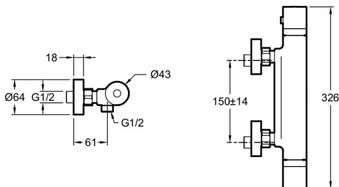
Descripción: Termostática de ducha mural. E24324. Colección: RIVOLI. DIMENSIÓN: 6 x 10,10 cm. PESO: 2,3 kg. MATERIAL: Metal. TIPO DE INSTALACIÓN: 2 orificios. TIPO: Monomando. RACORES: Con racores murales y embellecedores. MÉCANISMO: Cartucho de discos cerámicos. TIPO DE INSTALACIÓN: Mural. PARADA DE SEGURIDAD: 38°C. TEMPERATURA MÁXIMA: 50°C. GARANTÍA DEL MECANISMO: 5 años. GARANTÍA DEL ACABADO: 10 años. Caudal limitado 12 l/min.. Válvula anti-retorno..
