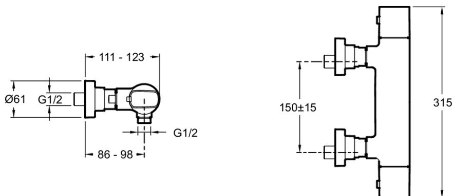
Descripción: Termostática ducha mural. E72352. Colección: ALEO. PESO: 2,7 kg. MATERIAL: Metal. TIPO DE INSTALACIÓN: 2 orificios. TIPO: Monomando. RACORES: Con racores murales y embellecedores. CONSUMO SOSTENIBLE: Sí. PARADA DE SEGURIDAD: 37°C. TEMPERATURA MÁXIMA: 50°C. GARANTÍA DEL MECANISMO: 5 años. GARANTÍA DEL ACABADO: 10 años. Tope de caudal sensitivo. Bloqueo de temperatura máxima a 50°C. Válvulas anti-retorno.
