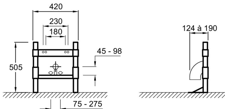
Descripción: Bastidor bidé pared ligera. E73011. Colección: Fuera colección. PESO: 12,2 kg. MATERIAL: N/A. TIPO DE INSTALACIÓN: Encastrado. GARANTÍA DEL BASTIDOR: 3 años. TIPO DE SOPORTE: Bastidor. FIJACIONES DEL BASTIDOR: suministrado con fijaciones murales. Recomendado para pared ligera. Regulable en profundidad.
