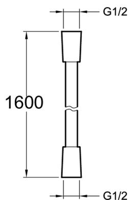
Descripción: Flexible de ducha 1600 mm. E75206. Colección: Fuera colección. DIMENSIÓN: 160 cm. PESO: 0,2 kg. MATERIAL: N/A. Flexible de 1,60 m aspecto liso acabado metálico y tuerca anti-torsión.
