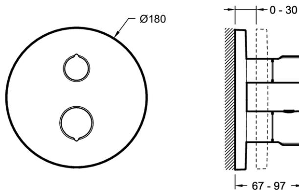
Descripción: Termostato con llave de paso e inversor 2 vías. E75390. Colección: MODULO. DIMENSIÓN: 18 x 18 cm. PESO: 3 kg. MATERIAL: N/A.
