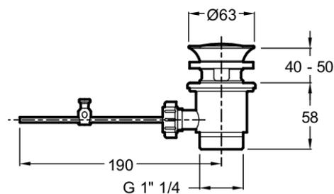
Descripción: Monomando de lavabo - desagüe automático. E75760-4. Colección: BRIVE. DIMENSIÓN: 47 x 48,60 cm. PESO: 1,4 kg. MATERIAL: N/A. TIPO DE INSTALACIÓN: 1 orificio. NORMAS Y REGLAMENTO: ACS: 14CCLY511. TIPO: Monomando. CAUDAL: 5 l/min. ALTURA TOTAL DE LA GRIFERÍA: 136. RACORES: Con flexibles de alimentación. MECANISMO: Cartucho con discos cerámicos. DESAGÜE: Con desagüe. GARANTÍA DEL MECANISMO: 5 años. DURACIÓN GARANTÍA (AÑOS): 5.
