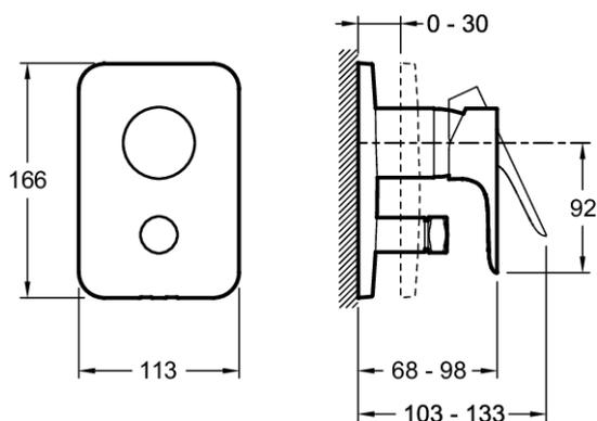
Descripción: Monomando para empotrar. E98717. Colección: ALEO. DIMENSIÓN: 24,50 x 16,50 x 11,50 cm. PESO: 2,6 kg. MATERIAL: N/A. TIPO DE INSTALACIÓN: Encastrado. Monomando para empotrar con inversor. Placa y palanca Aleo. Para instalar con Modulo 98699D.
