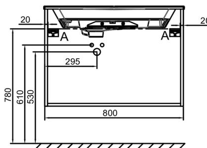
Descripción: Mueble bajo lavabo plano 80 cm, 2 cajones. EB2522M1-R7. Colección: ODÉON RIVE GAUCHE. DIMENSIÓN: 80 x 50,80 x 56,80 cm. PESO: 32 kg. MATERIAL: Lacado. TIPO DE INSTALACIÓN: Suspendido. FIJACIÓN: El instalador seleccionará las fijaciones adecuadas a la pared donde se va a instalar. INFORMACIÓN ADICIONAL: Grifería, lavabo plano y set de fijaciones no incluidas. GRIFERÍA RECOMENDADA: Odéon Rive Gauche. DURACIÓN GARANTÍA (AÑOS): 5.
