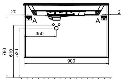
Descripción: Mueble bajo lavabo plano 90 cm, 2 cajones. EB2523M2-R8. Colección: ODÉON RIVE GAUCHE. DIMENSIÓN: 90 x 50,80 x 56,80 cm. PESO: 36,1 kg. MATERIAL: Lacado. TIPO DE INSTALACIÓN: Suspendido. FIJACIÓN: El instalador seleccionará las fijaciones adecuadas a la pared donde se va a instalar. INFORMACIÓN ADICIONAL: Grifería, lavabo plano y set de fijaciones no incluidas. GRIFERÍA RECOMENDADA: Odéon Rive Gauche. DURACIÓN GARANTÍA (AÑOS): 5.
