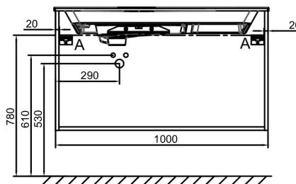
Descripción: Mueble bajo lavabo plano 100 cm - 2 cajones. EB2524M3-R5. Colección: ODÉON RIVE GAUCHE. DIMENSIÓN: 100 x 50,80 x 56,80 cm. PESO: 36,7 kg. MATERIAL: Lacado. TIPO DE INSTALACIÓN: Suspendido. FIJACIÓN: El instalador seleccionará las fijaciones adecuadas a la pared donde se va a instalar. INFORMACIÓN ADICIONAL: Grifería, lavabo plano y set de fijaciones no incluidas. GRIFERÍA RECOMENDADA: Odéon Rive Gauche. DURACIÓN GARANTÍA (AÑOS): 5.
